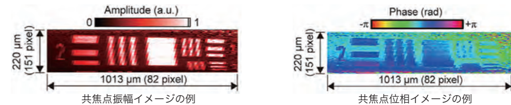
デュアルコム分光を用いたスキャンレス共焦点振幅 / 位相イメージング
